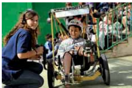
Le tricycle pèse 50 kilos pour deux mètres de long, un de large et 80 cm de haut. Sa vitesse maximale est de 52 kms/h
